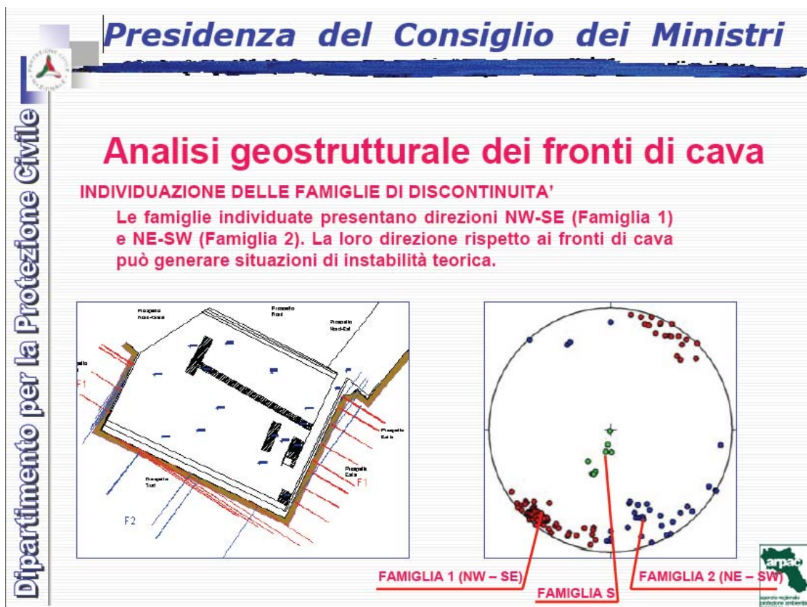
Figura 56: Sintesi che evidenzia l'orientamento delle due famiglie di discontinuità tettoniche rilevate dall'ARPAC.
