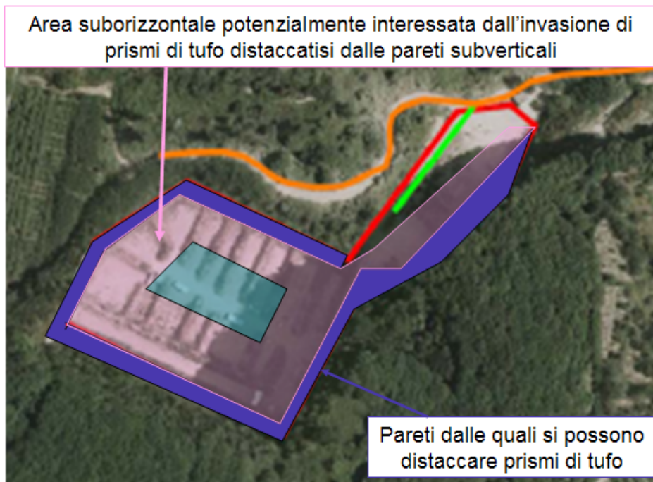
Figura 12: Nella figura è messa in evidenza la pericolosità geologica all'interno della cava in relazione al pericolo di crollo di prismi rocciosi, come riportato nella relazione del 28 aprile 2008
