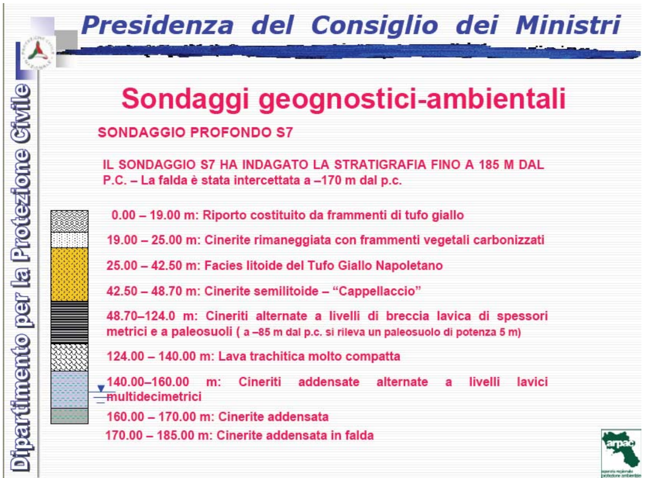
Figura 53: stratigrafia del sondaggio S7
